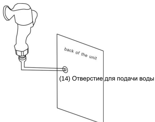
Рисунок В Подключение льдогенератора к водопроводу
